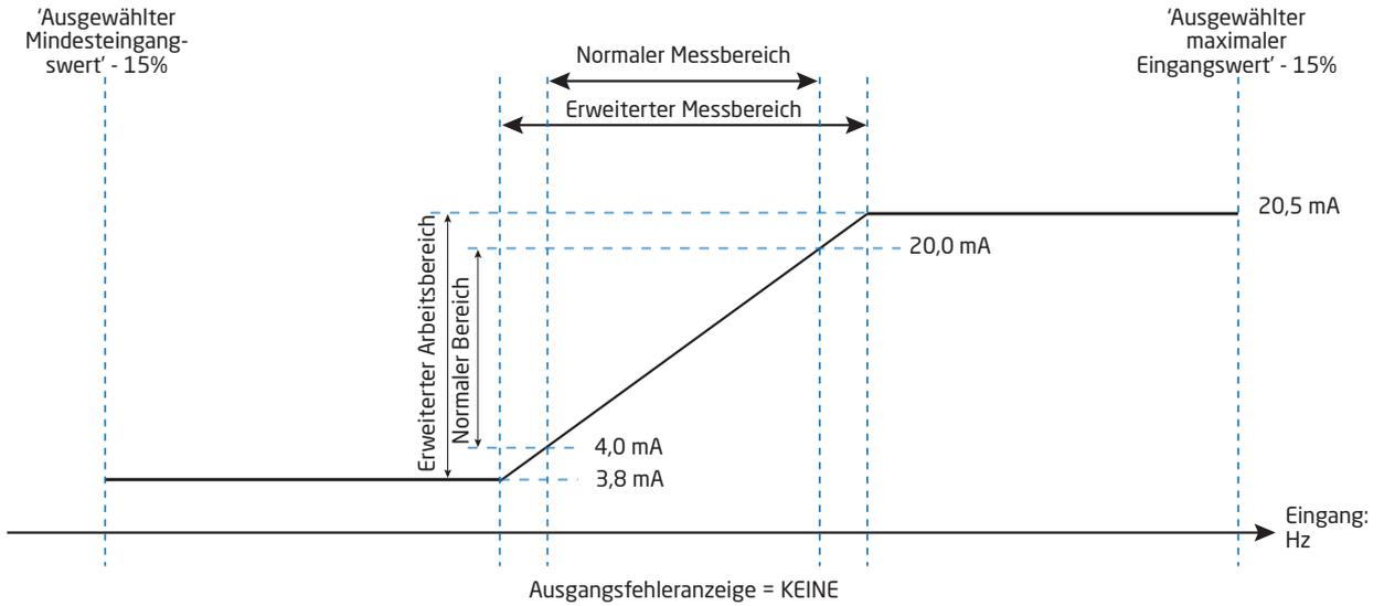
**Ausgangsgrenzwerte und Fehleranzeigen - Stromausgang**
