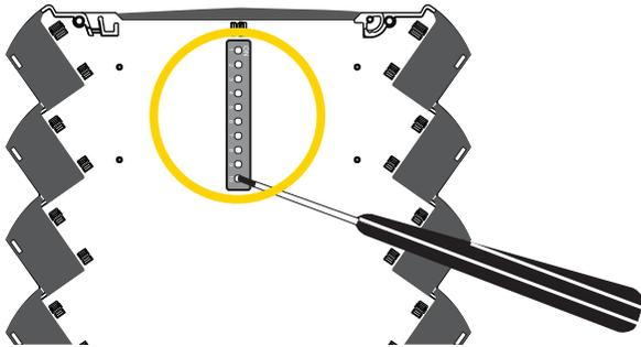
Standard-Werkeinstellungen (mit allen DIP-Schaltern in Position OFF):
